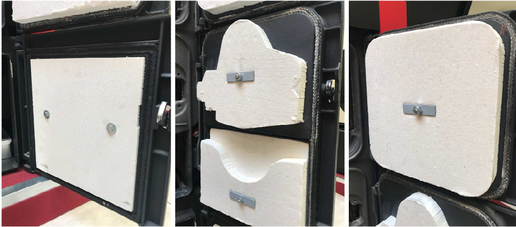
obr. č. 7 – izolace dvířek
