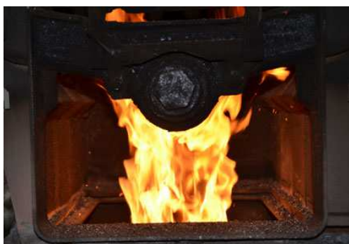
Obr. č. 15 Optimální tvar plamene
