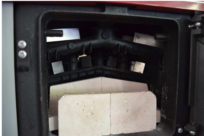
obr. č. 10 – vkládání turbulátorů a šamotových desek
