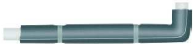
Obr. č. 39 – izolace trubek
